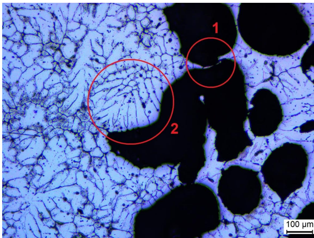
Figura 28 - Micrografia óptica da espuma com balões Fly Ash da malha 60 mostrando a interface da espuma com o disco inferior da liga AA6351.
