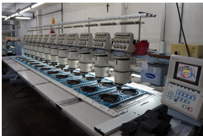
Figura 14- Máquina de bordar de 12 cabeças, cabeça cilíndrica. Fonte: Autoria própria-2013
