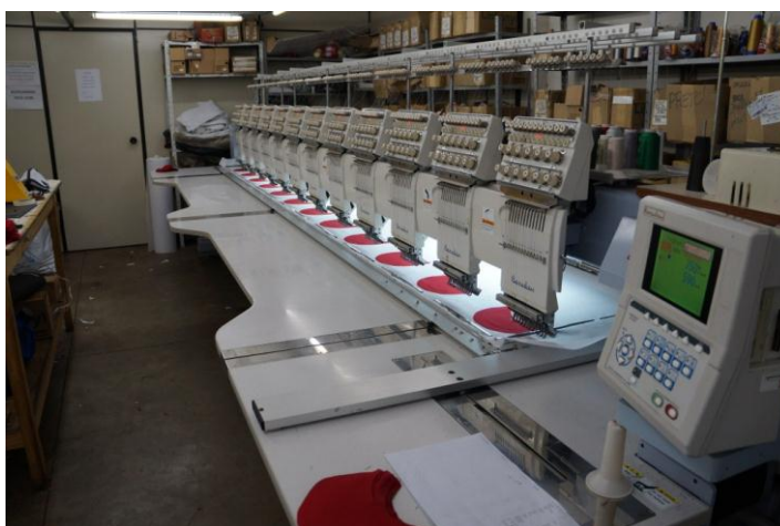
Figura 13- Máquina de bordar de 12 cabeças, cabeça reta. Fonte: Autoria própria, 2013.
