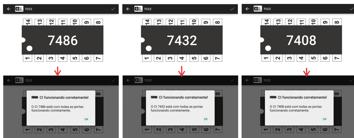
Figura 77 – 7486, 7432 e 7408 inseridos no soquete de verificação de erros Fonte: Autoria própria.
