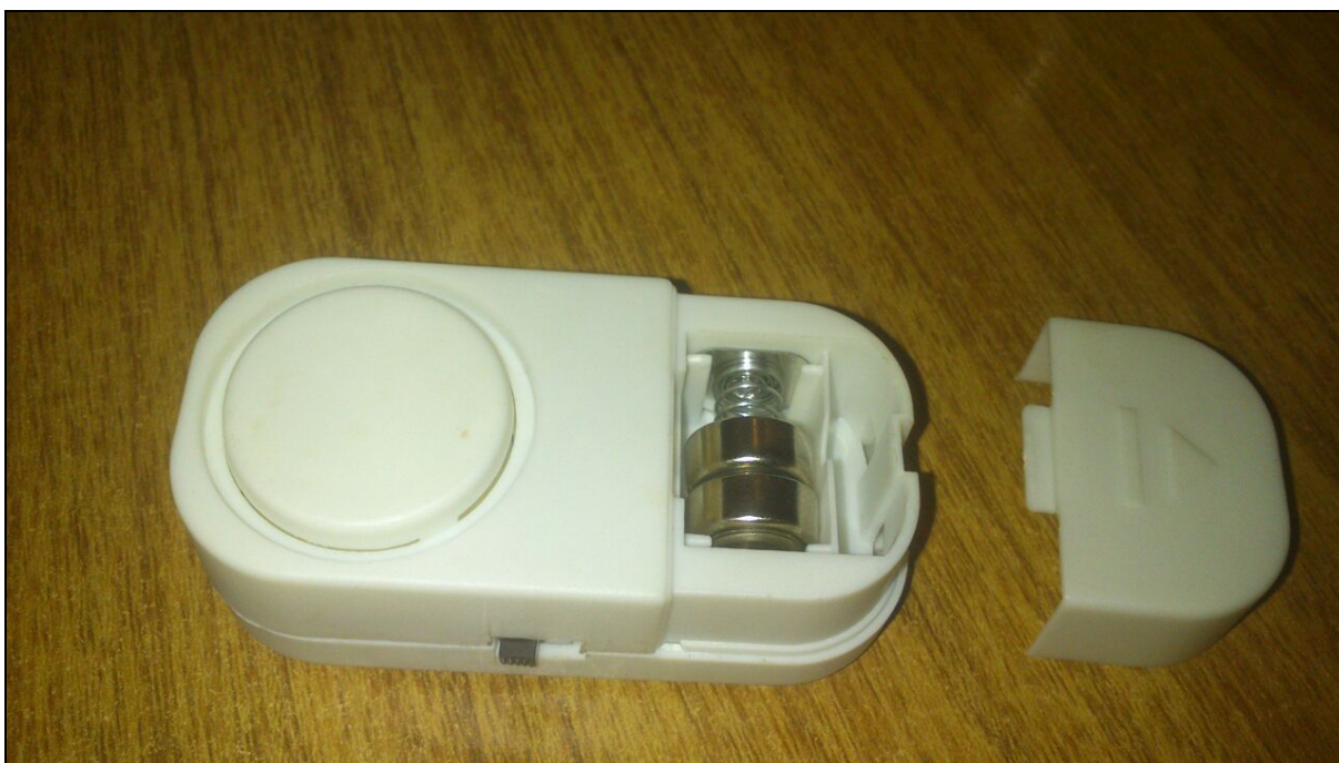
Figura 8 – Sensor magnético utilizado, com a caixa de baterias aberta Fonte: Autoria própria
