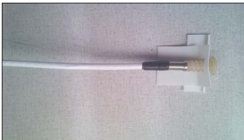
Figura 11 – Parte superior do sistema sensor, chapa fixadora. Fonte: Autoria própria
