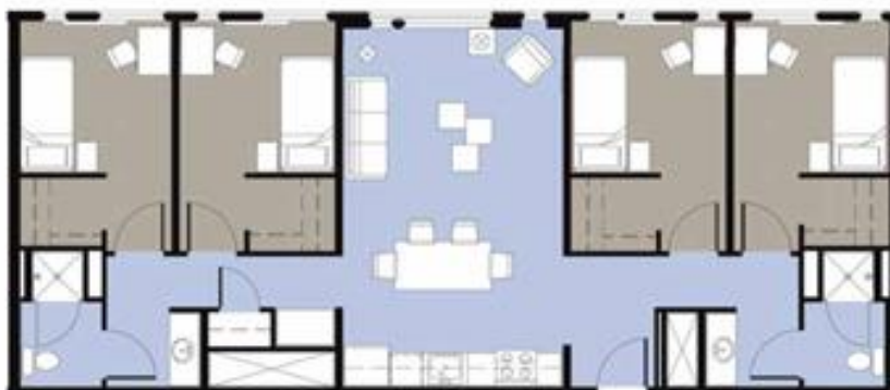
Figura 20. Exemplo de unidade coletiva para abrigar uma ou duas famílias, ou até quatro moradoras individuais. FONTE: Adaptado de Building Dignity , WSCADV.
