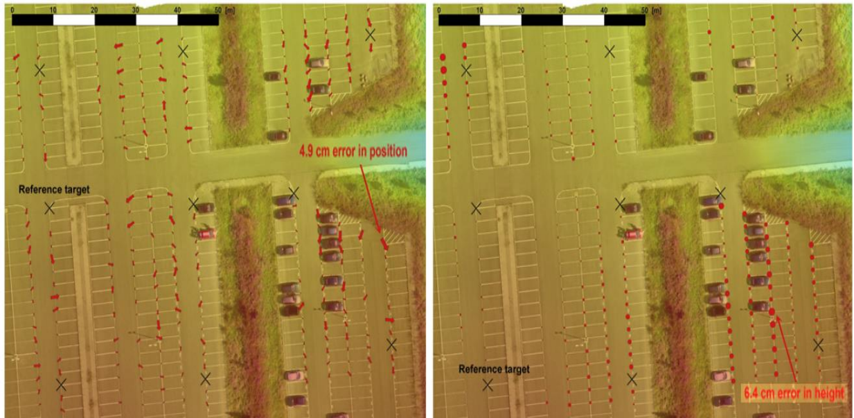
Figura 43 – Representação Gráfica de Erros Absolutos em Estacionamento Fonte: Adaptado de Siebert; Teizer (2014).
