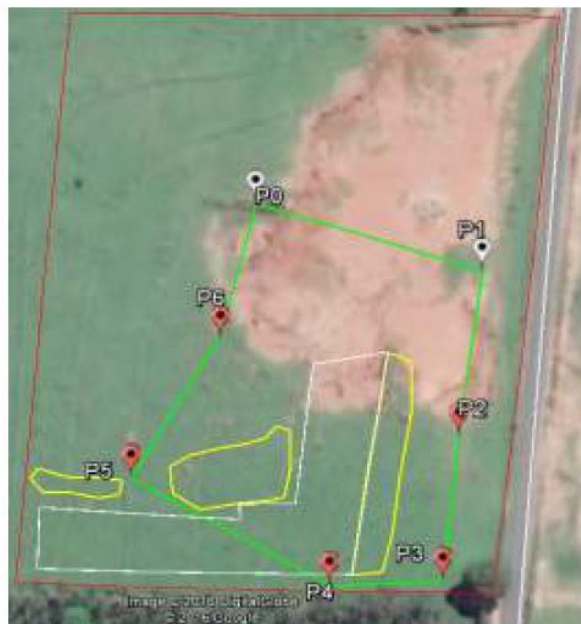
Figura 52 – Poligonal Fechada Fonte: DronEng (2016).
