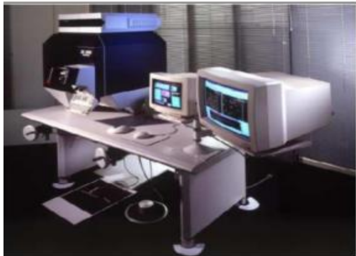
Figura 26 – Exemplo de Restituidor Analítico Fonte: Zaidan (2007, p.9)
