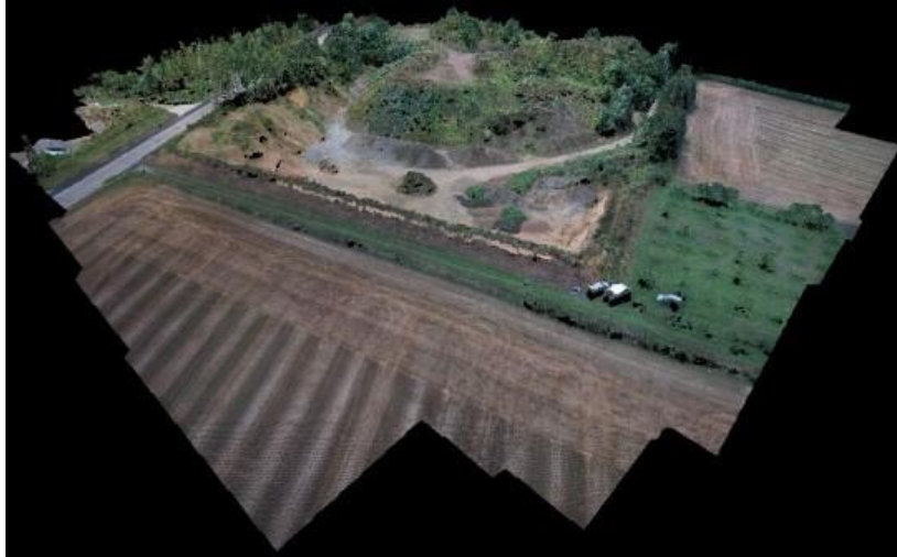
Figura 37 – Exemplo de Modelo Digital de Superfície Fonte: DronEng (2016).
