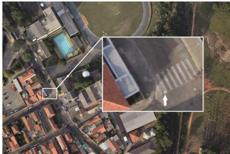
Figura 35 – Pontos de Controle Natural do Terreno Fonte: DronEng (2016).
