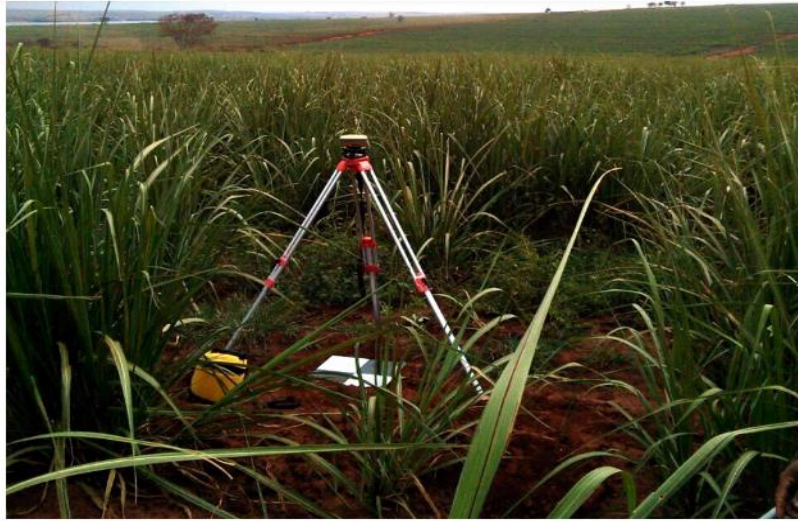
Figura 36 – Ponto de Controle Artificial Fonte: DronEng (2016).
