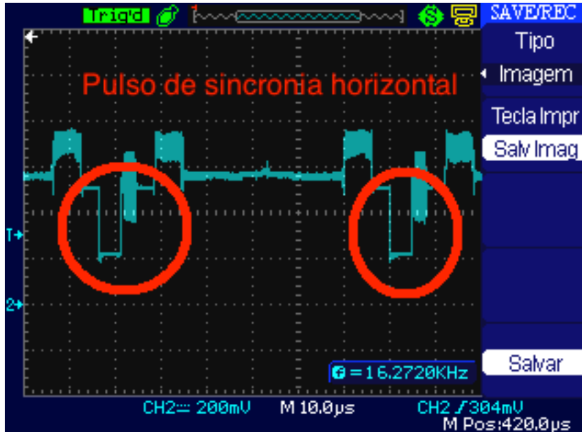
Figura 6 - Pulso de sincronia horizontal (parte negativa)
