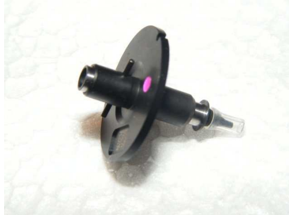
Figura 15 - Nozzle utilizado para montagem de placas Fonte: Alibaba (2012).
