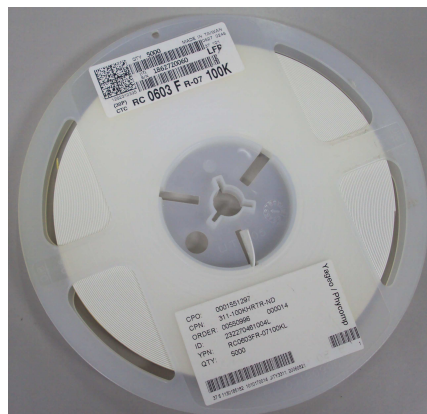
Figura 26 - Rolo de componentes eletrônicos SMD Fonte: Autoria própria.
