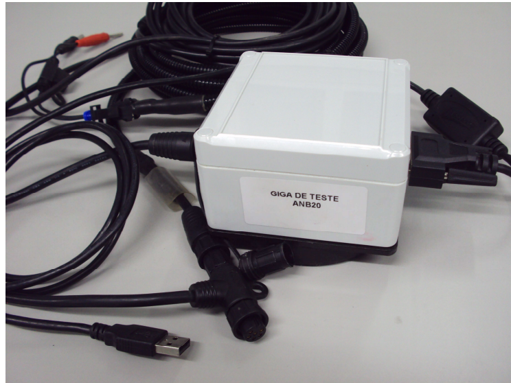
Figura 29 - Giga de testes desenvolvida para testes em placas Fonte: Autoria própria.
