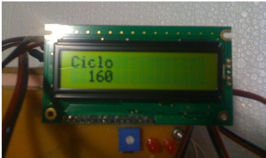
Figura 23 - Display LCD mostrando ciclo de operação Fonte: Autoria própria
