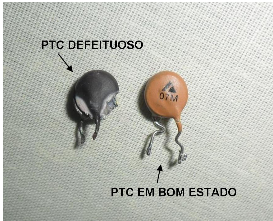
Figura 33 – Comparação entre PTC defeituoso e PTC em bom estado Fonte: Autoria própria
