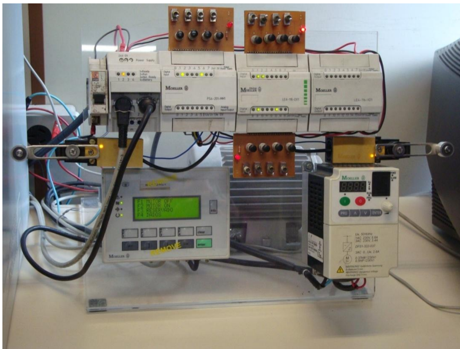
Figura 6 - PLC com módulos de expansão de entradas e saídas. Fonte: Laboratório D106 da UTFPR (2012).
