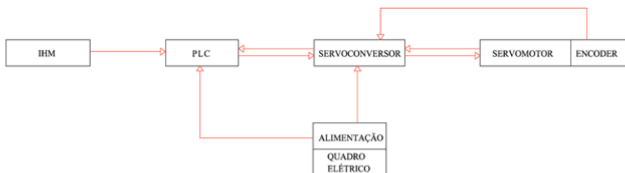
Figura 45 - Esquema de relação entre IHM, PLC e servoacionamento. Fonte: Autoria própria (2012).
