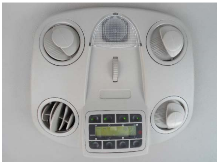
Figura 30 – Roof Cooler do VM – Pode ser utilizado com o motor ligado ou desligado
