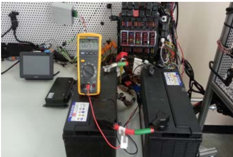
Figura 64 - Medição da corrente de referência na bancada
