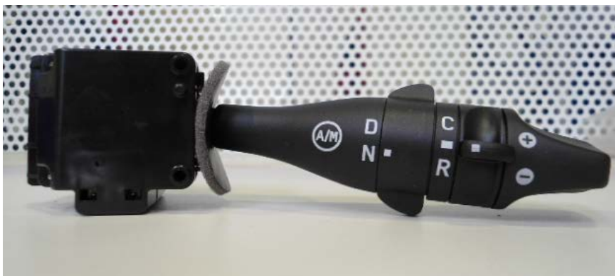
Figura 33 – Stalk utilizado para mudança de marchas em um veículo fabricado na Suécia
