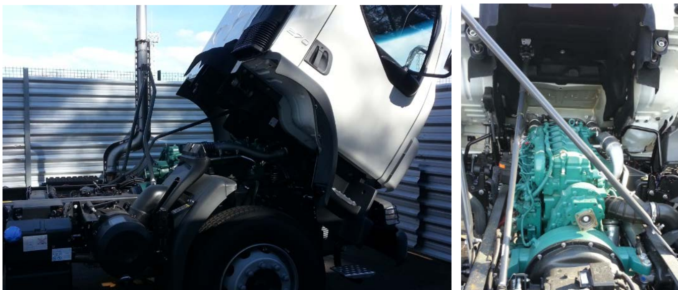
Figura 37 – Cabine do veículo VM basculada – mostra a dificuldade de acesso ao interior da cabine e ao alternador
