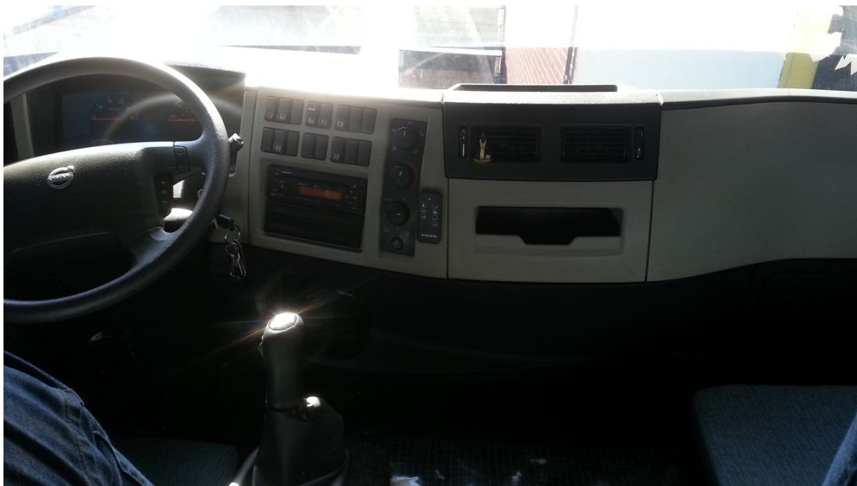
Figura 35 – Painel de instrumentos do veículo VM - mostra a dificuldade de acesso as unidades eletrônicas e chicotes no seu interior
