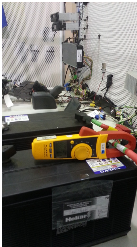
Figura 47 – Local da medição do teste de consumo na Box Truck
