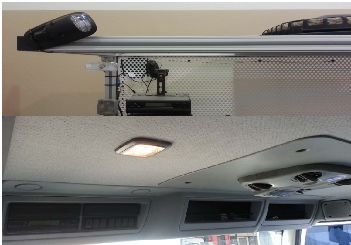
Figura 39 – Comparação de acesso às unidades eletrônicas localizadas na parte superior da cabine do veículo físico e sua disposição na Box Truck
