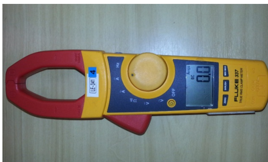
Figura 45 – Modelo de alicate amperímetro utilizado no teste de consumo de corrente.
