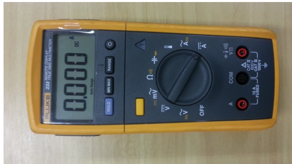
Figura 61 - Multímetro True RMS utilizado na medição
