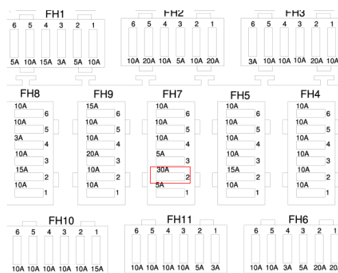
Figura 58 – Posição do fusível de proteção da ECU do motor
