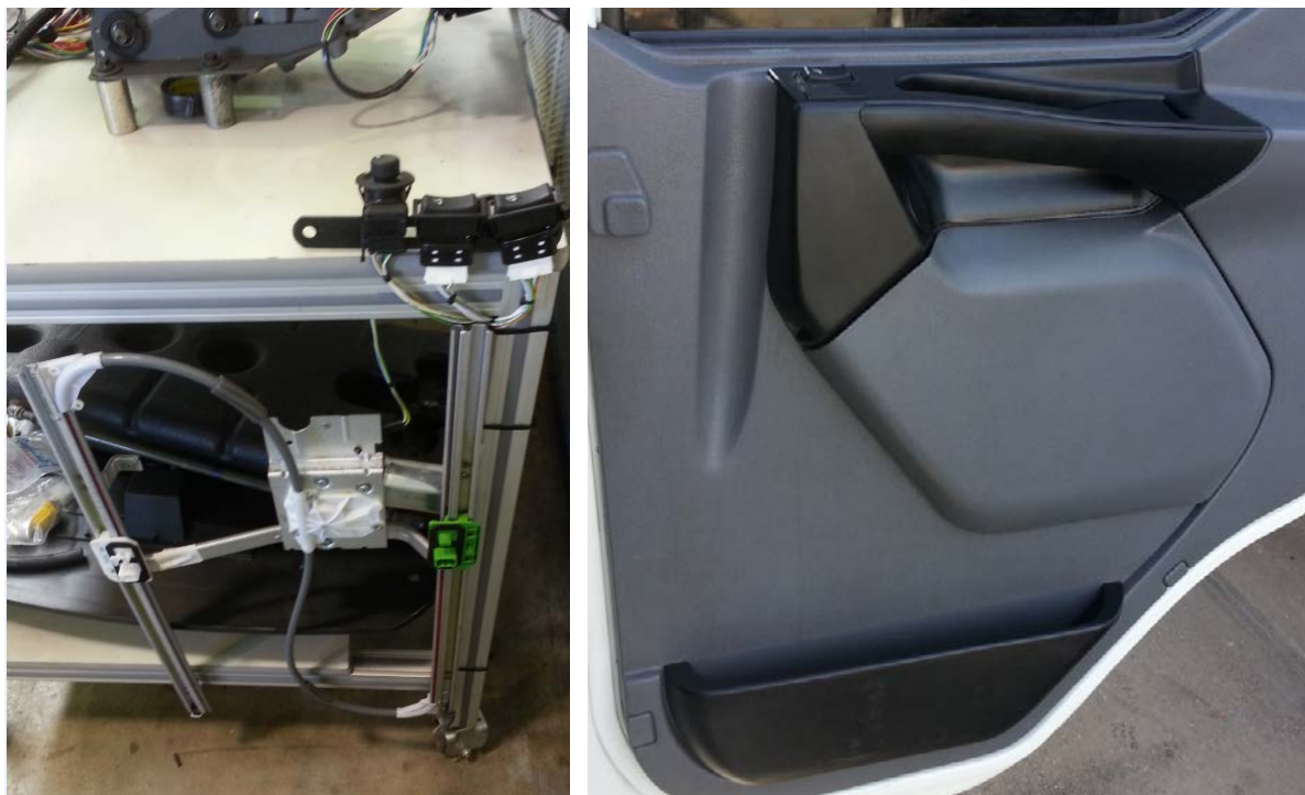
Figura 40 – Comparação de acesso das partes elétricas localizadas no interior da porta comparado ao acesso na Box Truck
