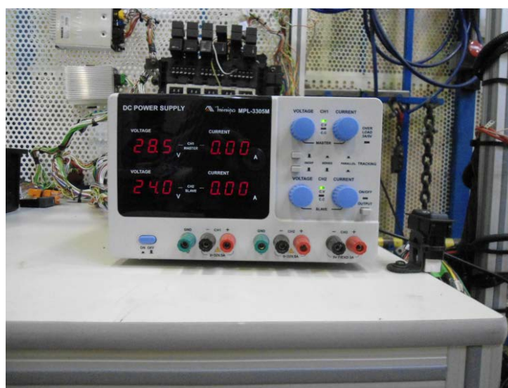
Figura 19 – Fonte CC utilizada para alimentação da bancada de testes para correntes pequenas
