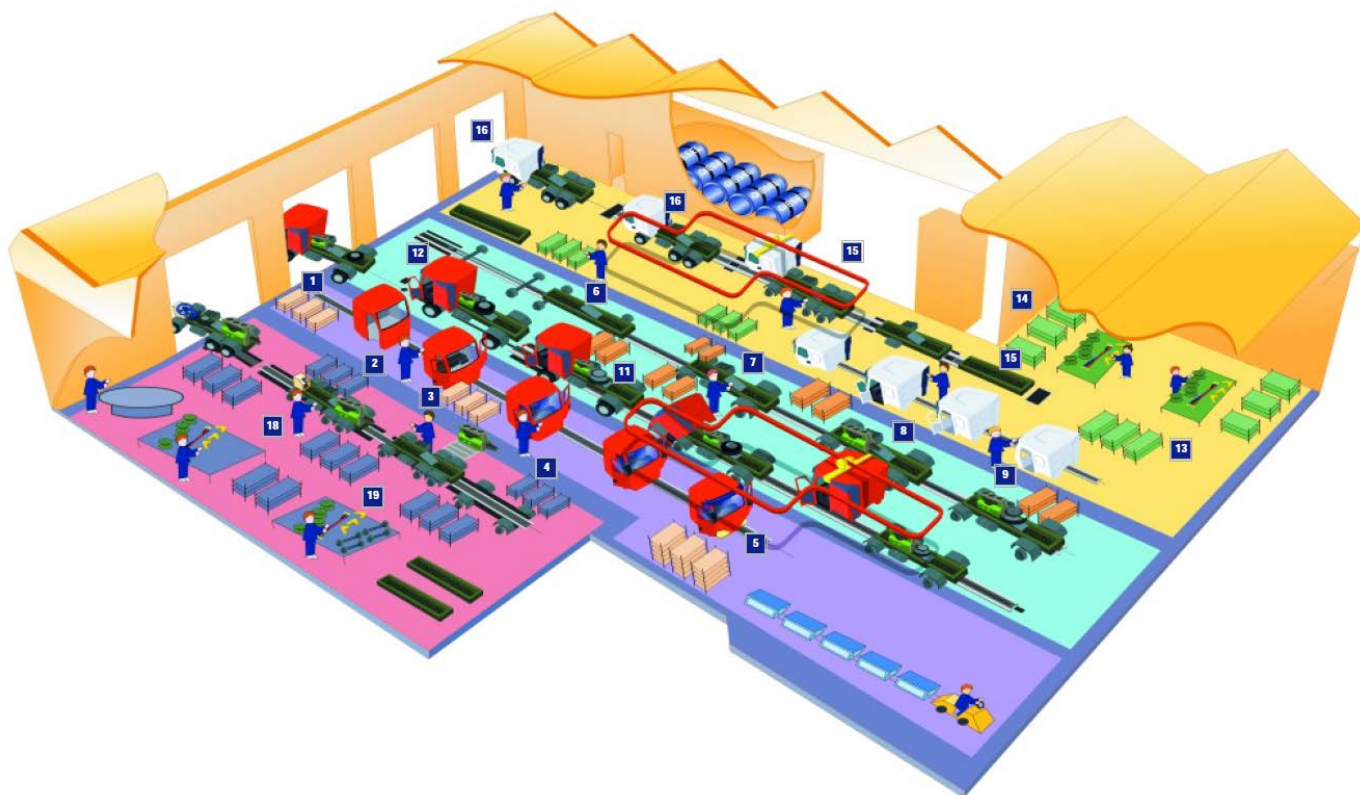
Figura 05 – Linha de montagem de caminhões e ônibus na Volvo do Brasil
