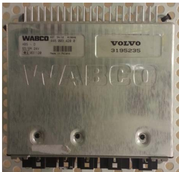
Figura 29 – Unidade do ABS canais que faz a distribuição eletrônica da frenagem
