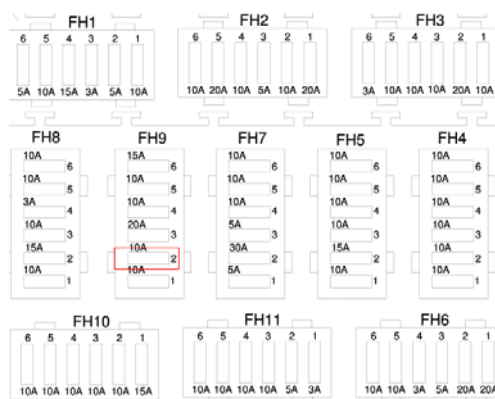
Figura 59 – Posição do fusível de proteção da Flash Unit
